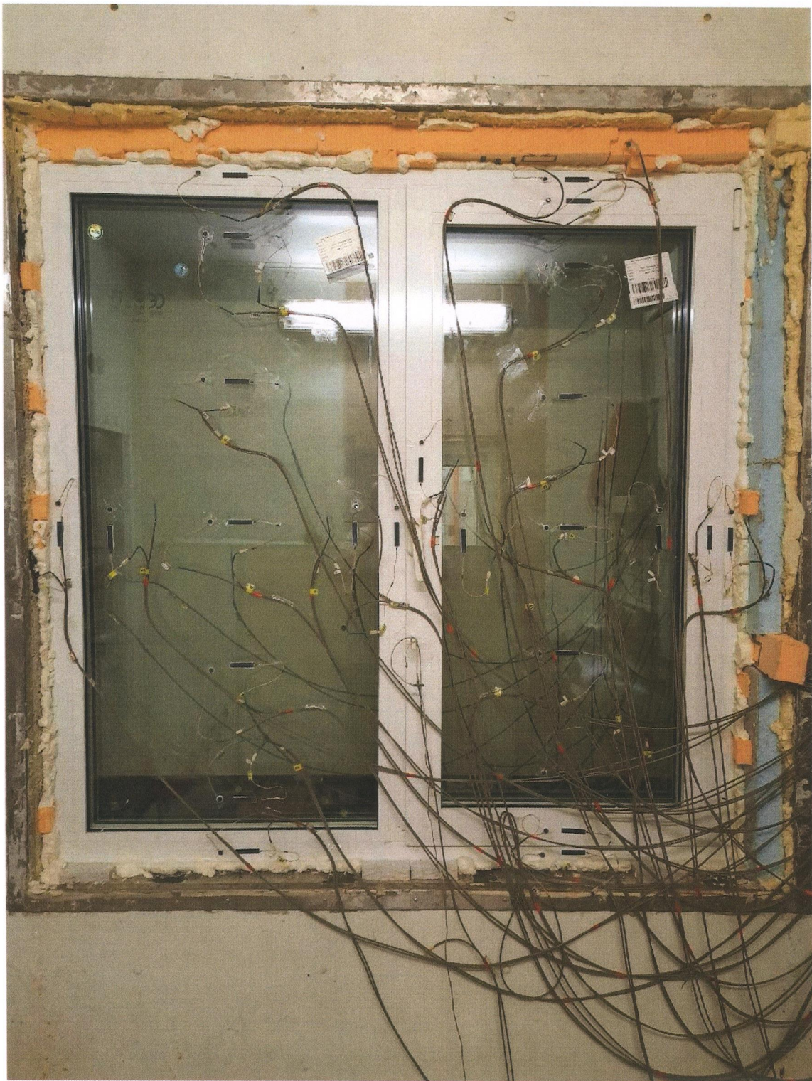
Рис.2. Внешний вид блока оконного, установленного в климатической камере.
