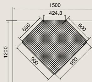
Вариант углового элемента 1050x1050 мм
